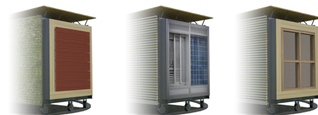
Componenti di facciata da testare in outdoor
